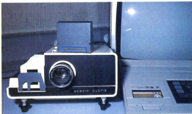
Le TO 7 peut maintenant piloter des diaporamas à l'aide d'une seule instruction Basic.
